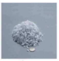
\*comparação do corte em partículas nível P3 ou superior com o corte em tiras (P1 e P2) e os cortes em partículas P3 ~P5 (as tiras se emaranham no cesto coletor, ocupando muito espaço e podendo se emaranhar nas lâminas de corte, gerando problemas como atolamento por excesso de papel, diferente do corte em partículas que são fragmentos compactos que rendem espaço no cesto pois se acomodam bem).
