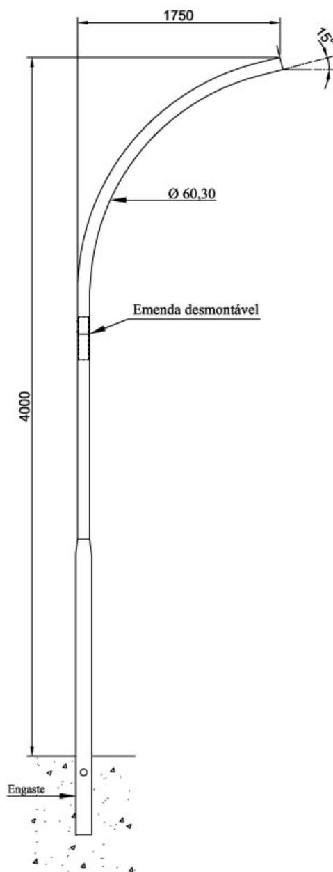
**Item 58:** Poste em aço galvanizado à fogo, reto, com 04 metros livre do solo, engastado sem janela de inspeção, conforme o croqui em anexo.
