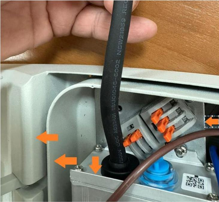
**FIG 3 – INTERIOR DA LUMINÁRIA COM DESTAQUE PARA O ACABAMENTO DAS ARESTAS ARREDONDADAS PARA EVITAR DANOS AOS CONDUTORES.**
